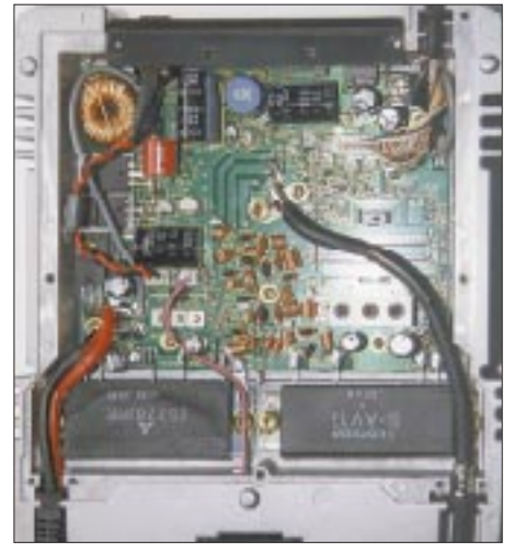
Blick in das Innere des Boosters CPB510E: Kräftige Module, Frequenzweichen, elektronische S/E-Umschaltung und Spannungsstabilisatoren bestimmen das Bild.
