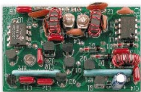
Bild 9: Für 29 US-Dollar kann man diesen hochwirksamen Noiseblanker als Option erwerben: Löt und Plug and Play
