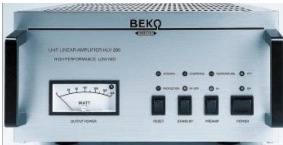
Bild 1: Understatement – Frontansicht der Leistungsstufe; rechts im Bild die vier Wippschalter, darüber die LEDs zur Anzeige der Betriebszustände und Schutzschaltungen
