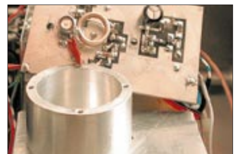
Der temperaturkompensierte VCO ist in einem dickwandigen Aluminiumgehäuse untergebracht.
