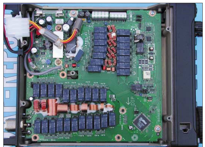
Bild 4: Die HF-Platine auf der Geräteunterseite wird von den beiden, mit Relais umgeschalteten Spulensätzen für Eingangsfilter (mitte) und Antennentuner dominiert.
