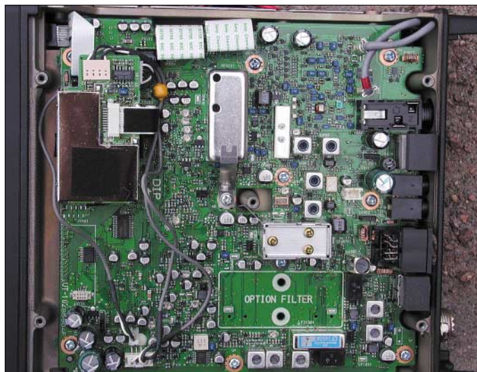
Bild 4: Die HF-Platine auf der Geräteunterseite wird von den beiden, mit Relais umgeschalteten Spulensätzen für Eingangsfilter (mitte) und Antennentuner dominiert.
