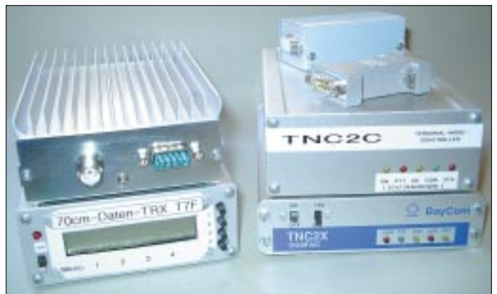
Bild 2: Das kleine Gerät spielt mit beliebigen TNCs oder Modems zusammen und eignet sich auch z.B. für SSTV im 70-cm-Band.
