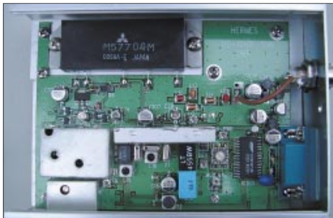
Bild 6: Blick in den Transceiver. Noch mehr SMD-Technik verbirgt sich auf der Unterseite. Oben kann zumindest der Speicherplatz ausgewählt und bei Bedarf die Sendeleistung abgeglichen werden.
